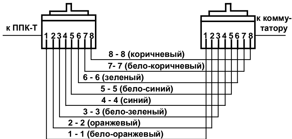
б) Прямая кросс-разводка (ППК-Т и коммутатор)
