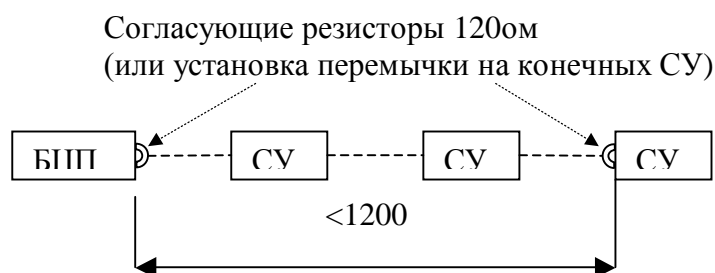
Рис. 6 Подключение сетевых устройств на линию RS-485.
