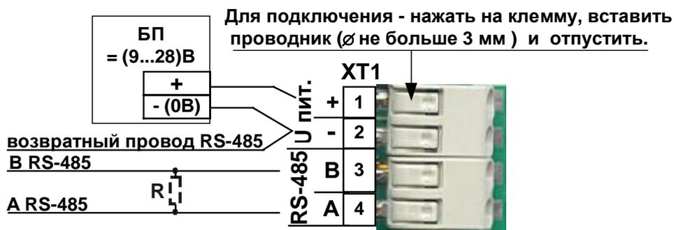
Если устройство является последним в линии связи RS-485 - необходимо между клеммами А и В установить резистор R 120 Ом  $\pm$  5 % 0,125 Вт.
