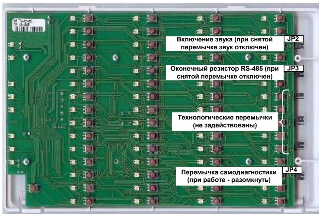
Рис. 4 Перемычки (вид со снятой передней крышкой, спереди).
