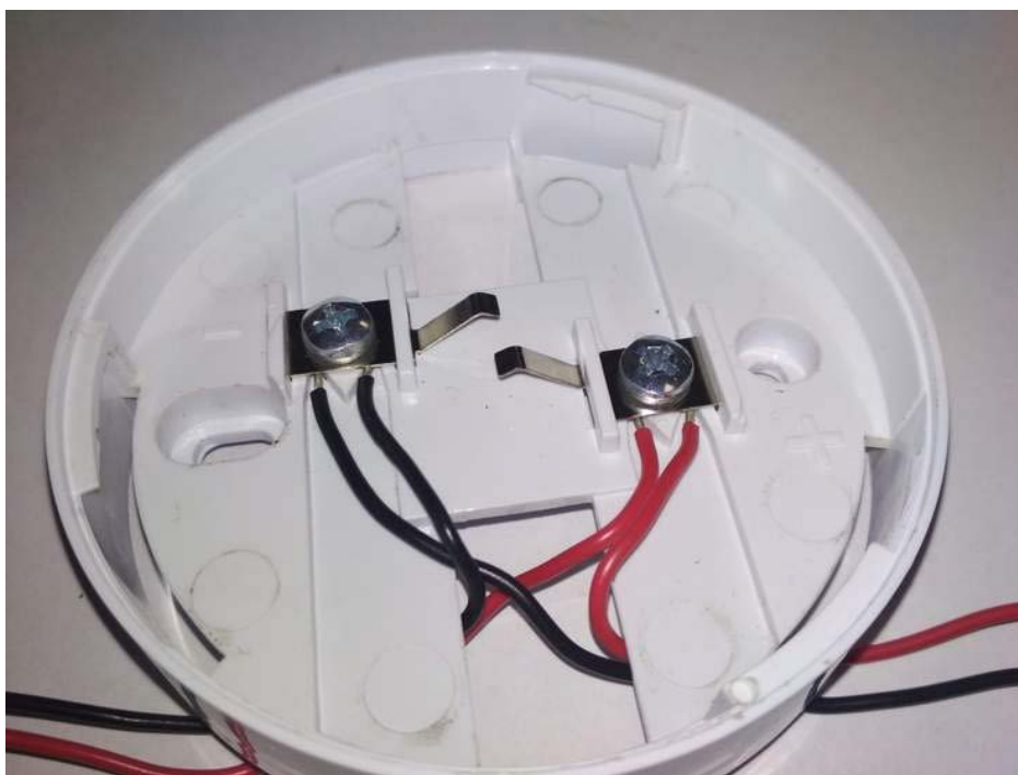
Рис. 4 Присоединение проводов к базе
