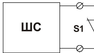
Рис. Схема 8 Подключение извещателя (датчика) с НЗ контактами без контроля целостности линии связи.
