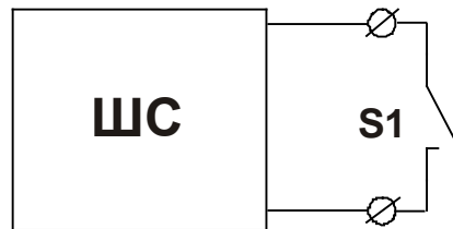
Рис. Схема 9. Подключение извещателя (датчика) с НР контактами без контроля целостности линии связи.
