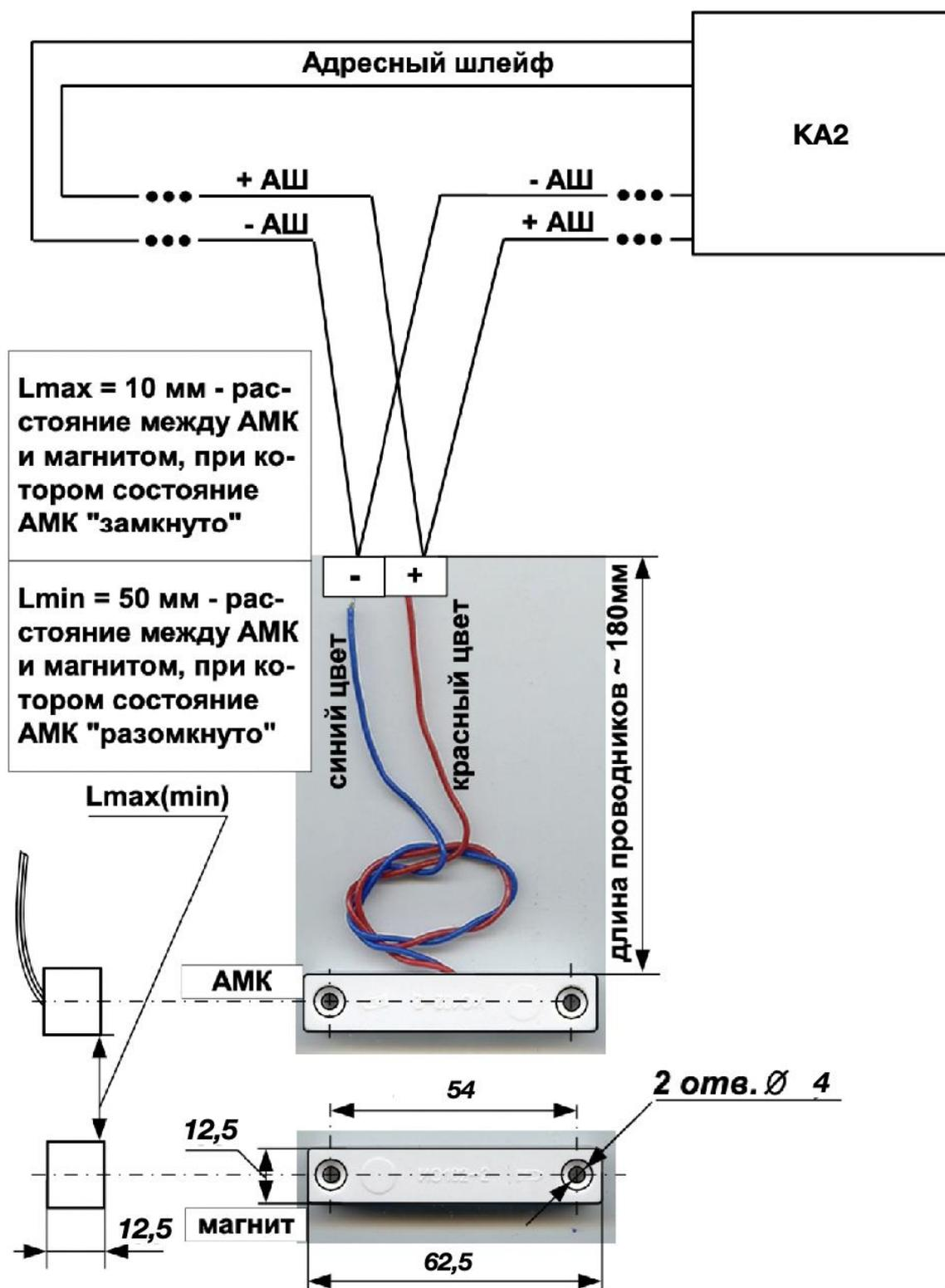
Рис. 1 Конструкция, подключение, габаритные и присоединительные размеры
