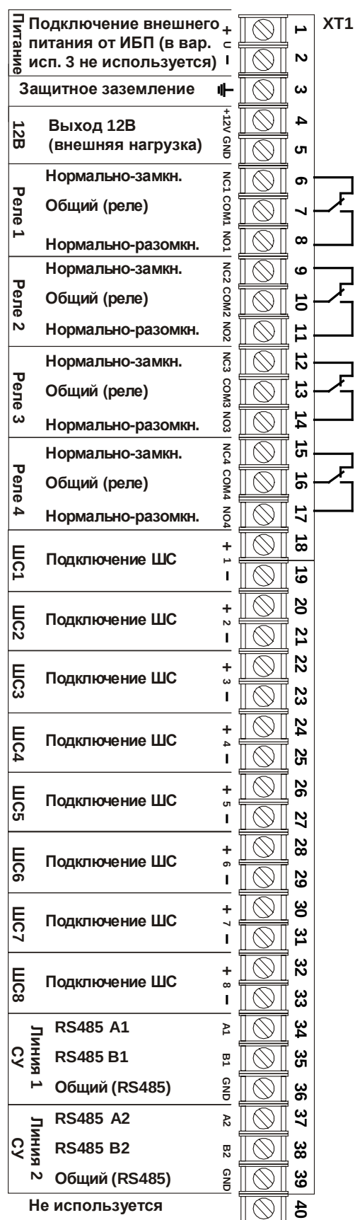
Рис. 17 Схема подключения БЦП (исп. 1,2)
