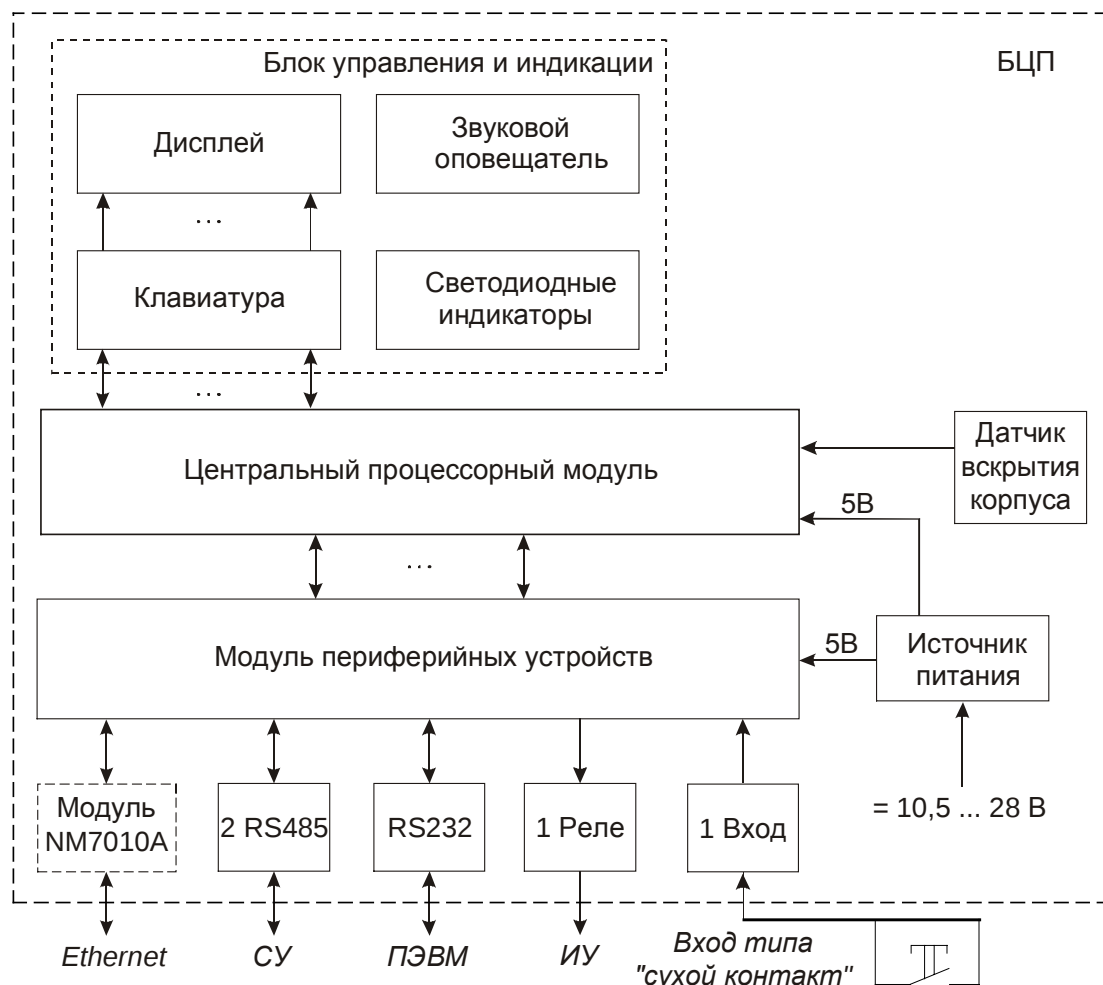
Рис. 6 Электрическая структурная схема БЦП Р-08 исп. 6
