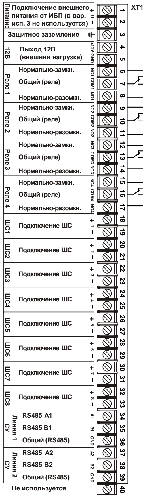
Рис. 32 Назначение разъемов XT1 БЦП исп. 2,3
