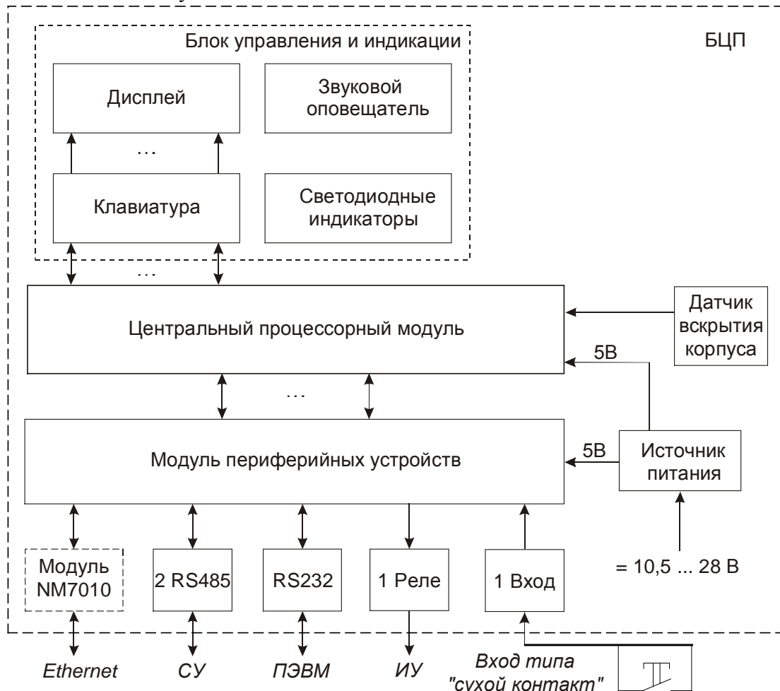
Рис. 6 Электрическая структурная схема БЦП Р-08 исп. 6
