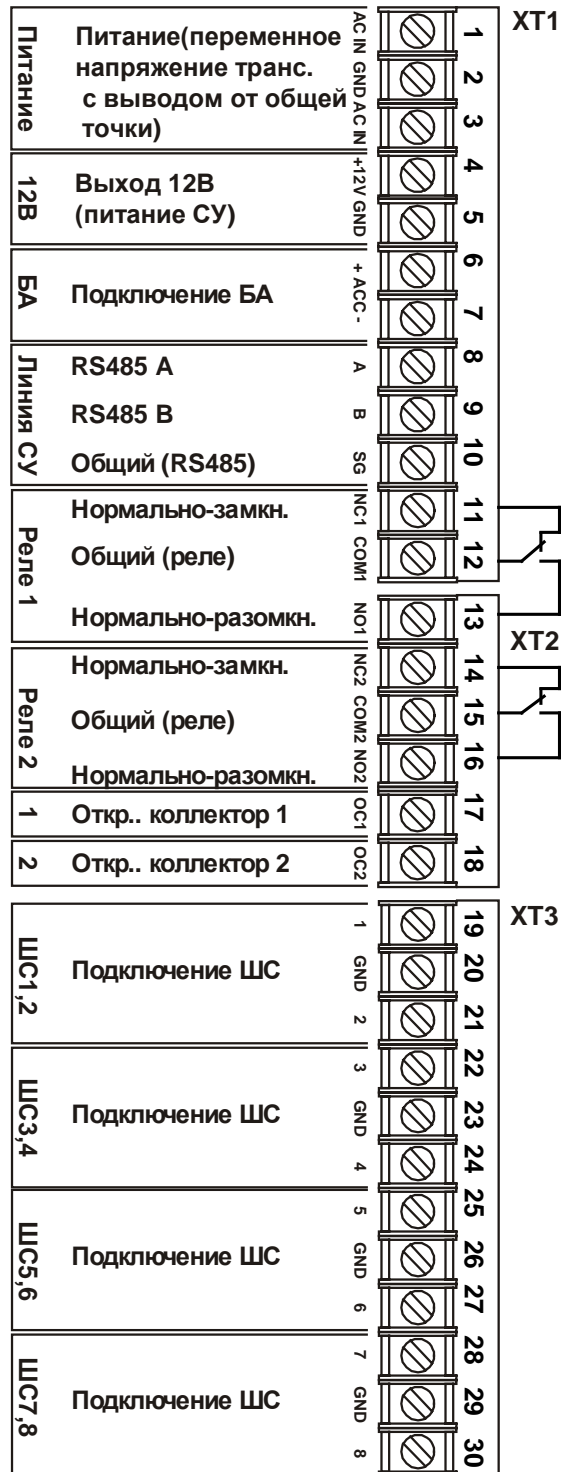
Рис. 35 Назначение разъемов ХТ1, ХТ2, ХТ3 БЦП исп.4
