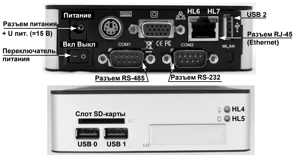
Рис. 4 Модуль процессорный, разъемы, индикаторы.
