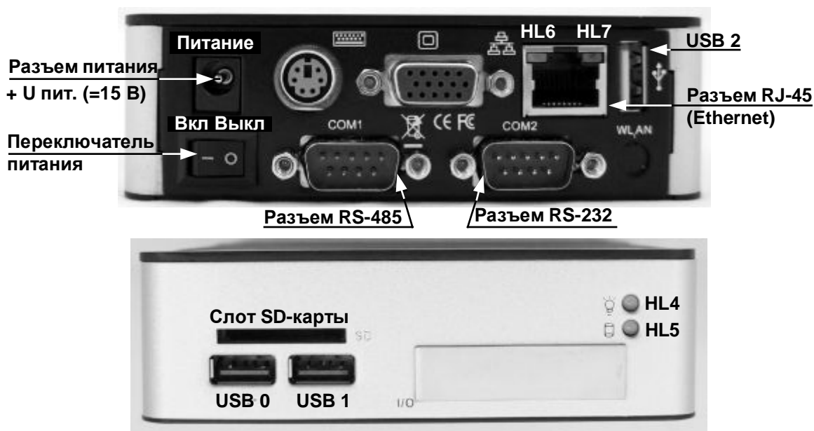
Рис. 5 Модуль процессорный, разъемы, индикаторы.
