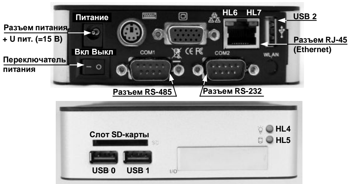
Рис. 5 Модуль процессорный, разъемы, индикаторы.
