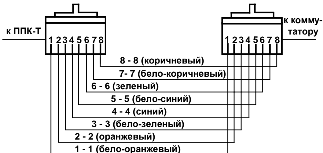
б) Прямая кросс-разводка (ППК-Т и коммутатор)
