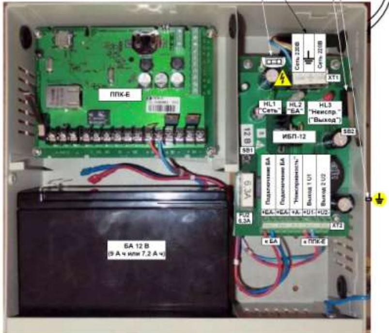
Внимание! Подключение защитного заземления осуществлять только в одной точке:
