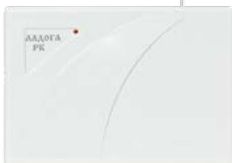
Предназначена для контроля состояния и управления режимами работы радиоканальных охранных и пожарных извещателей и других оконечных устройств и трансляции принятой информации на **выходные контакты реле**. Используется для объединения радиоканальной подсистемы с существующим на объекте оборудованием (обеспечивает возможность подключения к любому ПКП).
