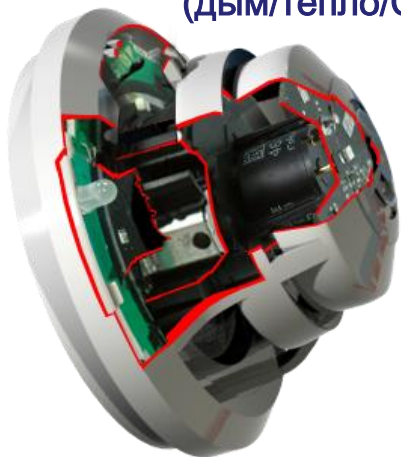
Извещатель 2251CTLE четырёхканальный (дым/тепло/СО/пламя-ИК)
