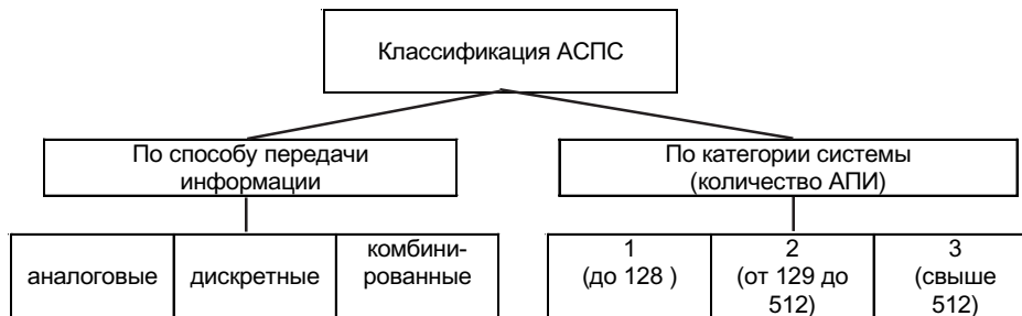
Рис. 2.2. Классификация адресных систем пожарной сигнализации
