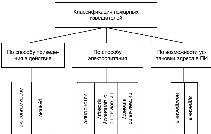
Рис. 2.5. Общая классификация пожарных извещателей.
