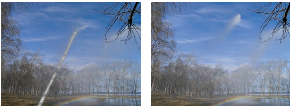
Рис. 7.24. Испытание импульсных насадков: слева — сплошная струя; справа — импульсный водяной заряд
