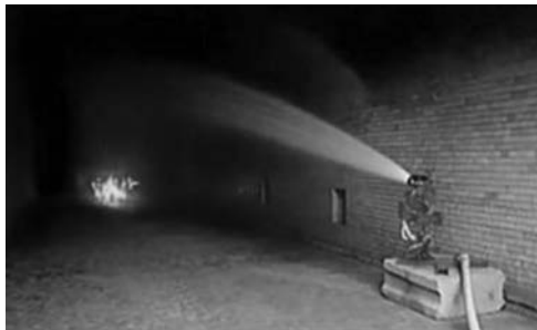
Рис. 10.41. Пожарный робот в тоннеле на испытаниях
