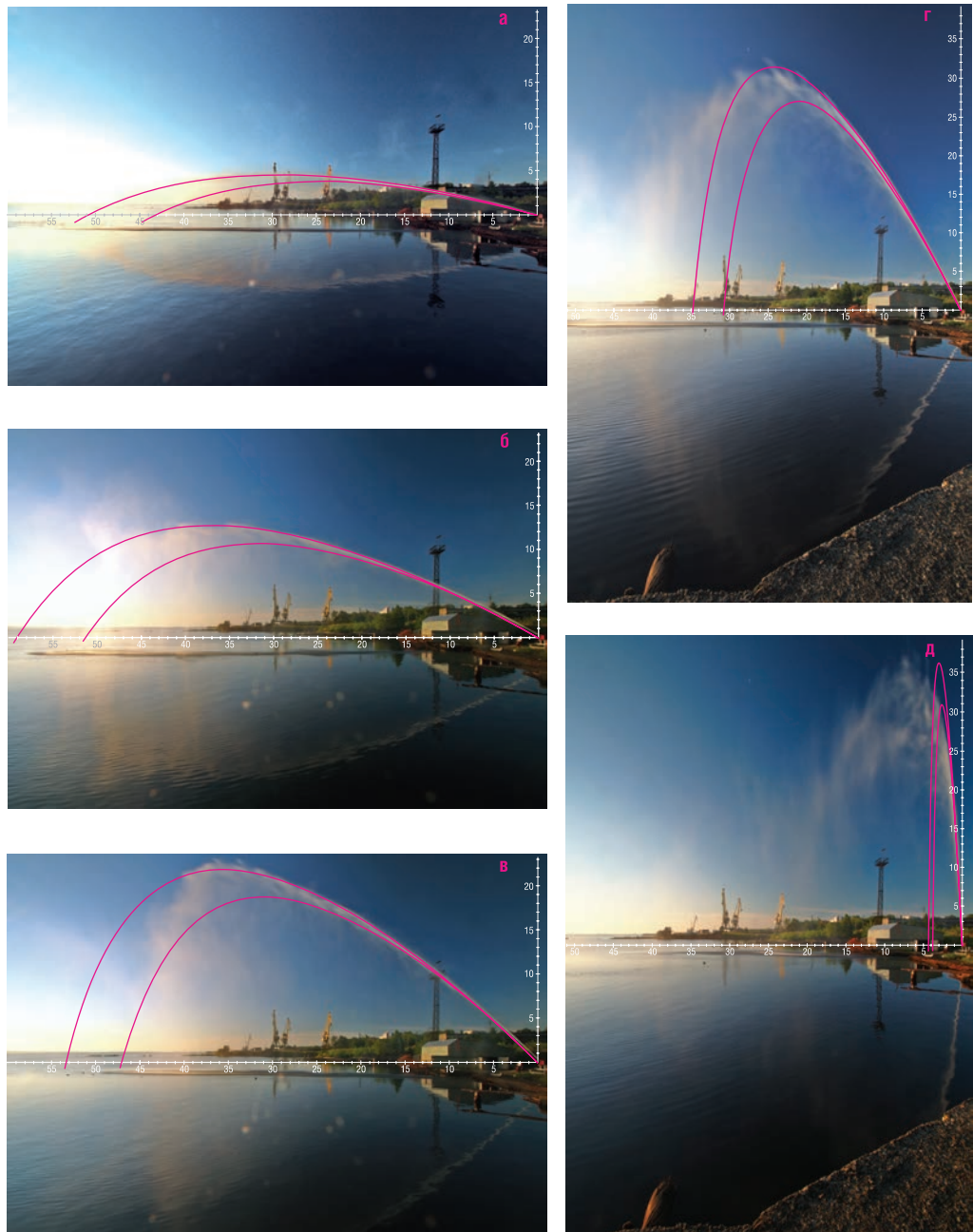
Рис. 3.22. Расчетные траектории струй для НР-20(10,15) при давлении 0,8 МПа, расходе 20 л/с, при разных углах наклона струи: а — 15°; б — 30°; в — 45°; г — 60°; д — 85°
