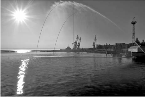
Рис. 3.10. Траектории сплошной и распыленной струй из распылителя НР-20(10, 15) при расходе 20 л/с, давлении 5 атм, угле распыления 45°, обзоре по горизонтали 54 м
