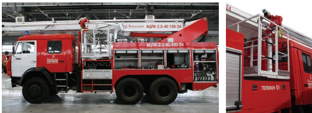
Рис. 8.13. Автомобиль АЦПК-2,0-40/100-24 с пожарным роботом на автоподъемнике
