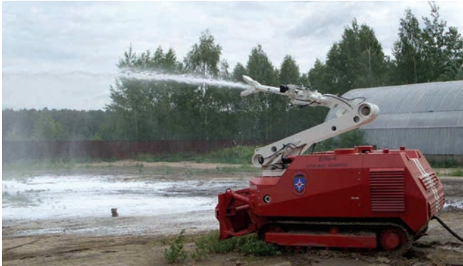
Рис. 8.16. Многофункциональный робототехнический комплекс пожаротушения среднего класса ЕЛь-4
