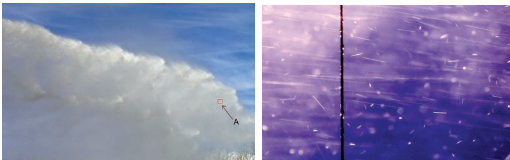
Рис. 8.17. Jet Fog, или «летающий туман» (слева) с видом А в увеличенном масштабе (справа) (выдержка – 1/1000 с, диаметр струны – 200 мкм, размер капли в фокусе – от 50 до 400 мкм)
