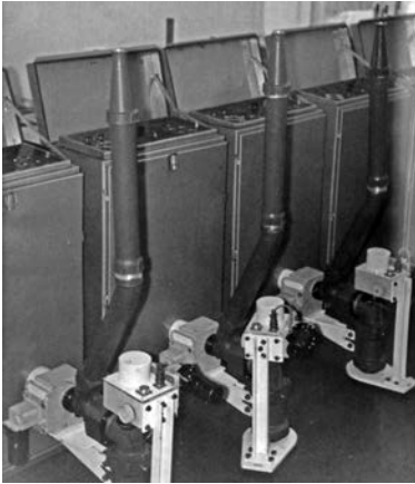
Рис. 1.17. Партия пожарных роботов для Ленинградской АЭС
