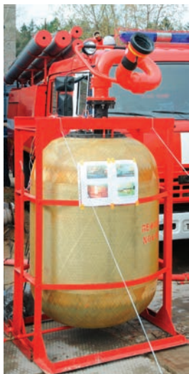
Рис. 9.23. Установка УПАТ-2000 с лафетным стволом
