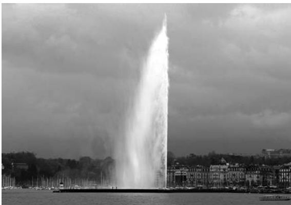
Рис. 2.11. Фонтан Jet d'Eau в Женеве (выбрасывает 500 л/с воды со скоростью 55 м/с на высоту 140 м)
