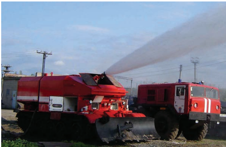
Рис. 7.35. Пожарный танк с лафетным стволом ЛСД-С100У
