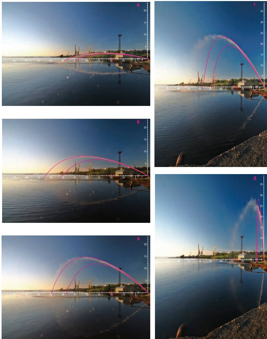
Рис. 3.20. Расчетные траектории струй для НР-20(10,15) при давлении 0,4 МПа, расходе 20 л/с, при разных углах наклона струи: а — 15°; б — 30°; в — 45°; г — 60°; д — 85°
