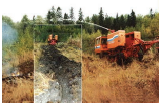
Рис. 34. Лесопожарный трактор на испытаниях в условиях среды применения
