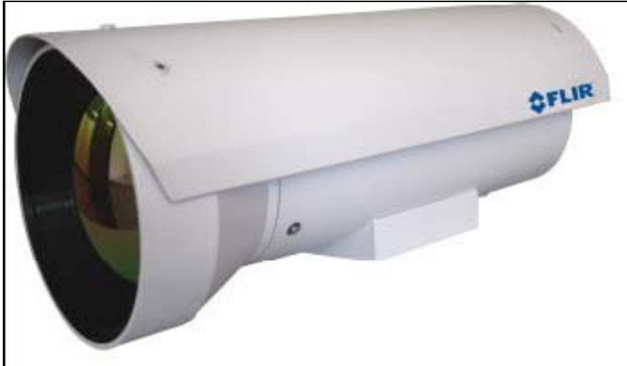
Рис. 91 - Тепловизор «Ranger II/III» на основе матрицы InSb
