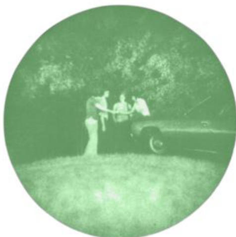
Рис. 80 - Зависимость изображения в ЭОП от уровня естественной подсветки объекта наблюдения
