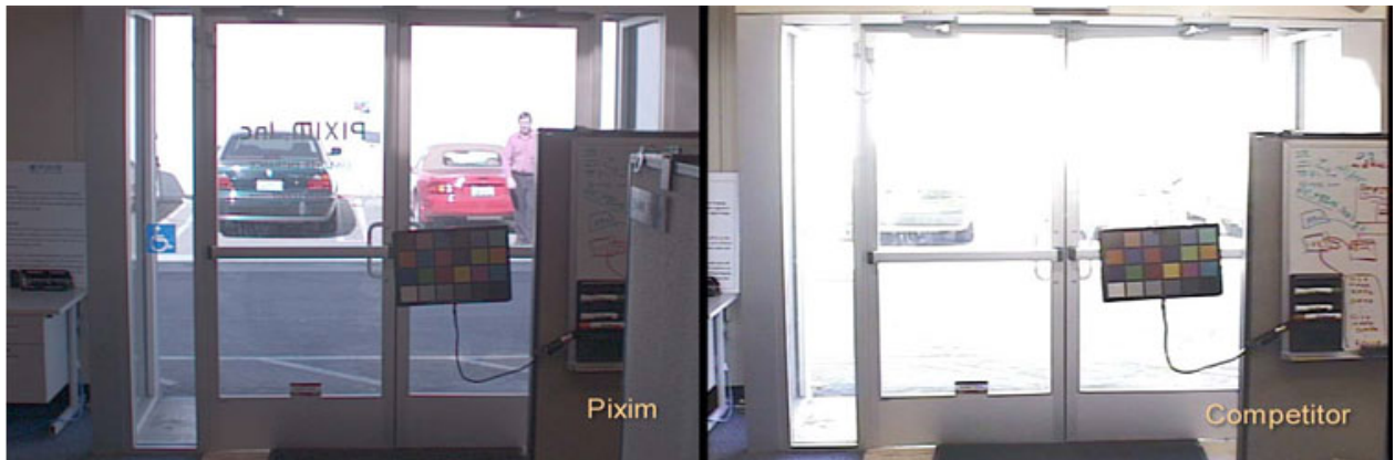
Рис. 109 - Изображение при интенсивной световой засветке для камеры построена на технологии DPS (Pixim) (расположена справа) и ПЗС расположена слева.
