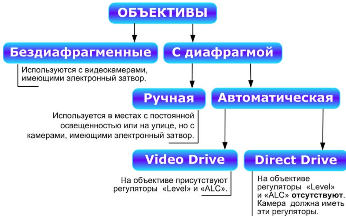
Рис. 3 - Группы объективов по управлению диафрагмой
