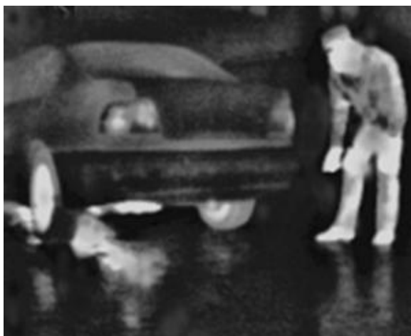
Рис. 99 - Тепловизионная картинка тепловизора «ТН-4604 МБ» (дельта T=5^{\circ}\text{C} )
