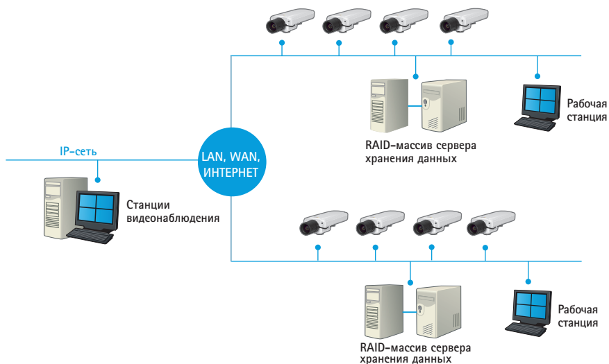
РИС 12.6e Большая система видеонаблюдения с распределенной архитектурой.
