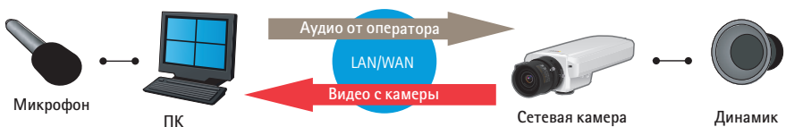
РИС 8.3б На этом примере симплексного режима звук передается от оператора на видеокамеру. Применяется, например, чтобы сделать предупреждение человеку, находящемуся в кадре видеокамеры, или отпугнуть угонщика на автомобильной парковке.
