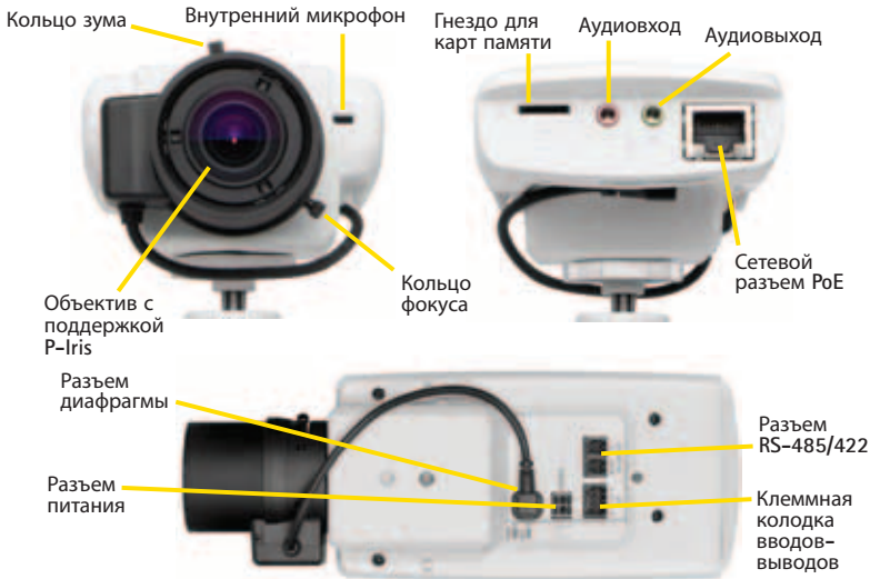
РИС 2.1b Сетевая видеокамера: вид спереди, сзади и снизу.
