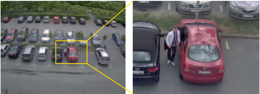
РИС 2.4d Слева показано масштабированное в меньшую сторону 5-мегапиксельное изображение. А справа увеличенный фрагмент, содержащий движущийся объект, в разрешении VGA без ухудшения качества, полученный при помощи приложения AXIS Digital Autotracking.
