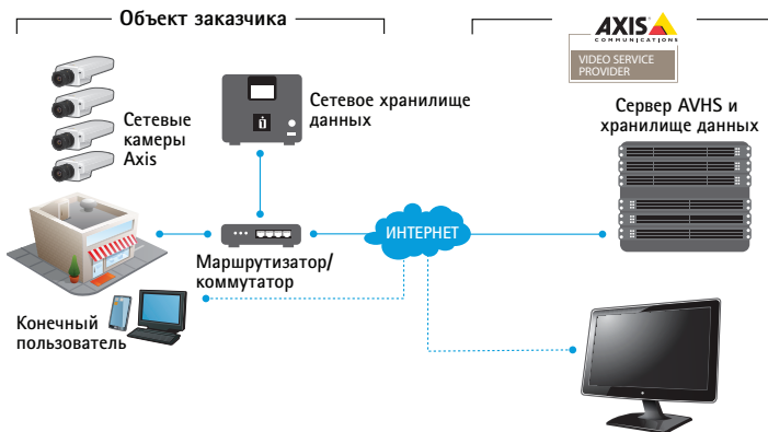
РИС 11.1с Сервис видеохостинга AXIS Video Hosting System и хранение видеозаписей вне объекта. Пользователь может просматривать изображение с камер наблюдения и воспроизводить видеозаписи, подключившись к порталу провайдера видеохостинга.
