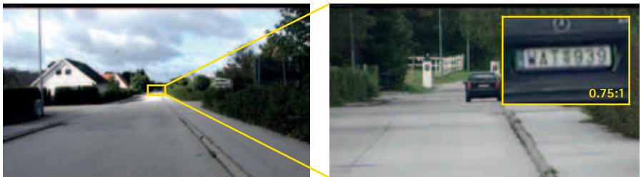
РИС 2.4j Слева показано изображение общего плана, а справа увеличенный в 20 раз фрагмент изображения. Оба кадра сделаны купольной PTZ-видеокамерой стандарта HDTV 1080p. Как видно, можно прочитать номерной знак автомобиля, находящегося на расстоянии 275 м (900 футов) от видеокамеры.
