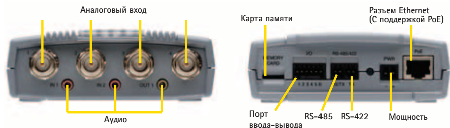
РИС 4.1б Четырехканальный корпусный видеокодер с передачей звука, входами и выходами для подключения внешних устройств, например, датчиков и устройств аварийного оповещения, последовательными портами (RS-422/RS-485) для управления аналоговыми PTZ-видеокамерами, портом Ethernet с поддержкой питания по сети (PoE) и слотом карт памяти для хранения видеозаписей.
