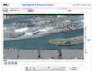
РИС 2.41 Благодаря функции маскирования (на изображении показано серыми прямоугольниками) можно скрыть конфиденциальные участки помещения, чтобы они не были видны в кадре.
