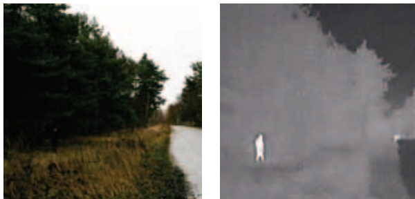
РИС 2.2е Слева показан кадр, полученный с обычной видеокамеры. А справа кадр с тепловизионной камеры.
