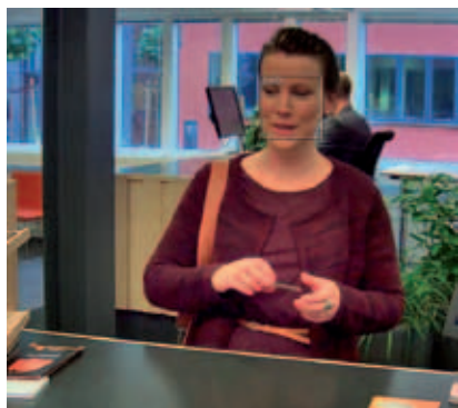
РИС 2.3с Функция подсчета количества пикселей от компании Axis выглядит как рамка со счетчиком, показывающим количество пикселей по ее ширине и высоте. При помощи данной функции очень удобно проверить, например, является ли количество пикселей достаточным для идентификации личности или нет.
