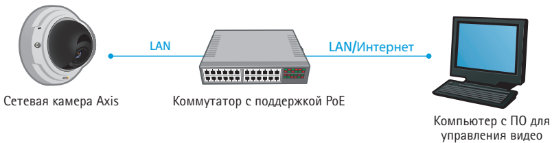
РИС 2.1а Сетевая видеокamera, подключенная к локальной сети.
