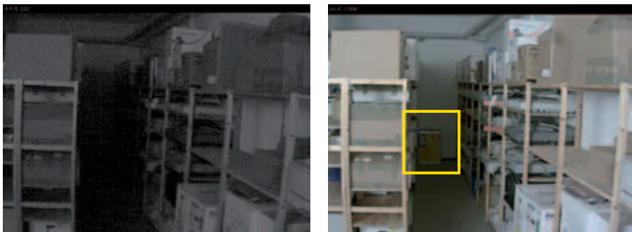
РИС 2.2c Изображение (уровень освещенности 0,4 лк у задней стены), показанное слева, получено с видеокамеры, переключенной в ночной режим. А изображение справа получено с видеокамеры, оснащенной технологией Lightfinder и продолжающей работать в дневном режиме. Как видно, изображение цветное и достаточно детализированное, например, как на коробке, на полу у задней стены.
