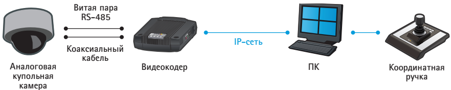
РИС 4.4а Команды управления аналоговой купольной PTZ-видеокамерой можно передавать через последовательный порт видеокодера (например, порт RS-485). Таким образом, реализуется дистанционное управление по локальной сети.
