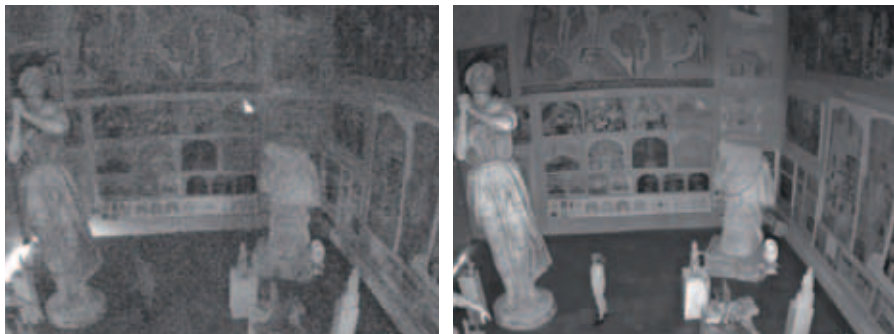
РИС 2.2b Слева показано изображение, сделанное в ночном режиме без инфракрасной подсветки (в результате, видеокамера использует только немного света, идущего из-под двери в левом углу комнаты). А справа показано изображение, сделанное в ночном режиме с инфракрасной подсветкой.
