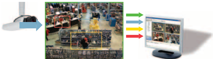
РИС 2.4е Одна видеокамера с матрицей 1Мп+. Общий план, фрагменты которого можно передавать отдельными видеопотоками. В результате получается до восьми виртуальных видеокамер
