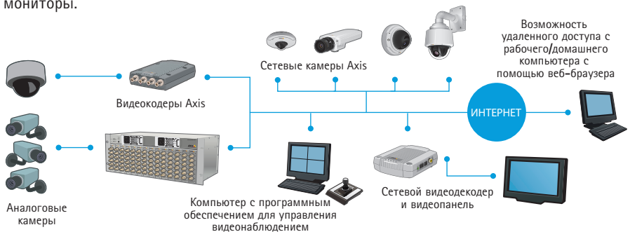
РИС 4.1а Пример интеграции аналоговых видеокамер и аналоговых мониторов в систему сетевого видеонаблюдения при помощи видеокодеров и декодеров.
