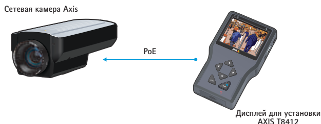
РИС 3.7а Портативный прибор с аккумуляторным питанием AXIS T8414 очень удобен для точной настройки параметров видеокамер на месте установки. Прибор AXIS T8414 легко подсоединяется к видеокамере и снабжает ее электропитанием, и в плане удобства гораздо предпочтительней ноутбука, потому что в некоторых ситуациях ноутбуком пользоваться очень неудобно, например, стоя на лестнице или находясь на некоторой высоте над землей.
