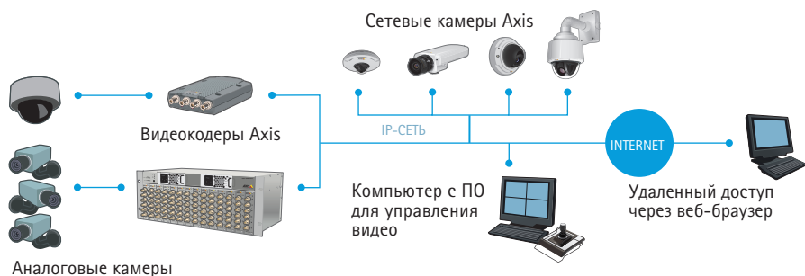
РИС 1.1а В состав системы сетевого видеонаблюдения входят разные компоненты, например, сетевые видеокамеры, видеокодеры и программное обеспечение видеонаблюдения. Все другие компоненты являются стандартным ИТ оборудованием, включая хранилища данных, серверы и сетевую аппаратуру.
