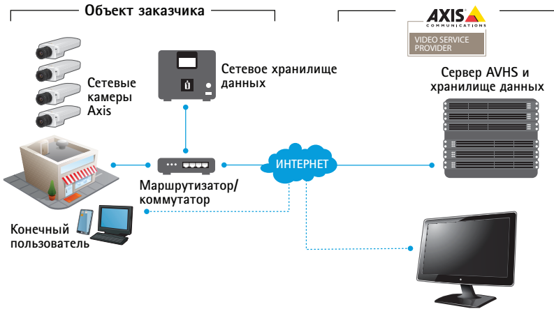
Рис 12.6b Система видеонаблюдения, использующая видеохостинг. Потребуется провайдер услуг видеохостинга со своими серверами, провайдер услуг видеонаблюдения, видеокамеры/видеокодеры. Доступ к видеоматериалу осуществляется по своей учетной записи на портале в сети Интернет
