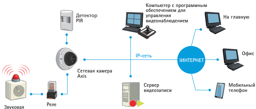
РИС 11.2d Благодаря обработке событий и функциям видеонаблюдения система видеонаблюдения может постоянно отслеживать входящие сигналы и оперативно реагировать на события. В случае тревоги система автоматически выполняет заданные действия, например, включает видеозапись и рассылает предупредительные сообщения.
