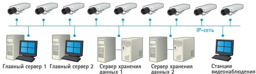
РИС 12.6d Большая централизованная система видеонаблюдения.
