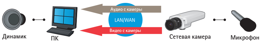
РИС 8.3а В симплексном режиме звук передается только в одном направлении. В данном случае, он передается оператору с видеокамеры. Применяется в системах видеонаблюдения и удаленного мониторинга.
