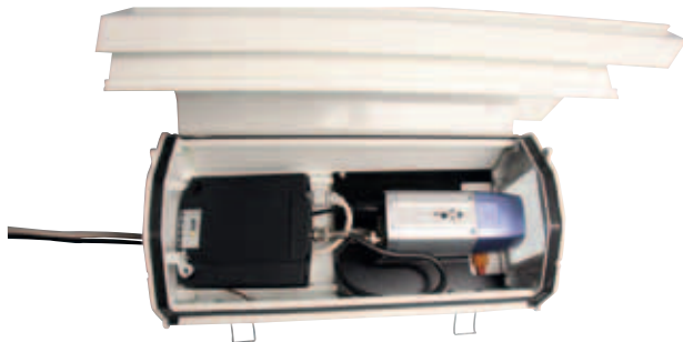
РИС 4.2б Пример расположения компактного одноканального видеокодера прямо внутри корпуса аналоговой видеокамеры.
