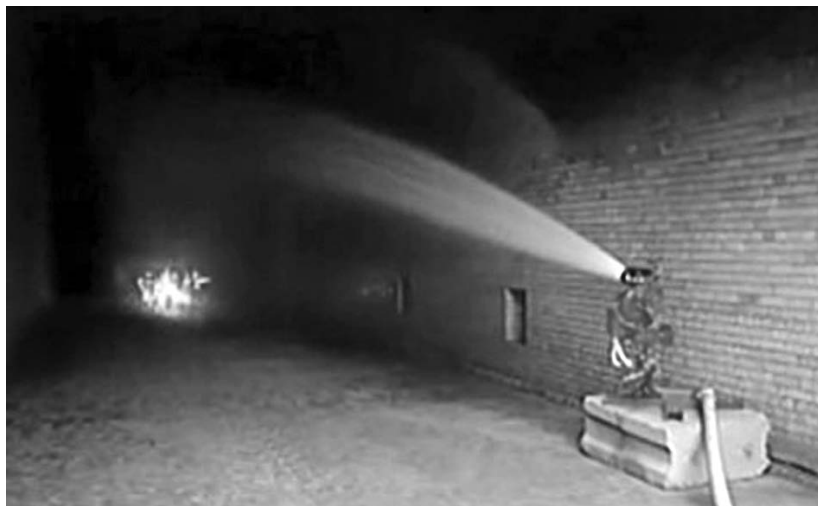
Рис. 9.11. Испытания пожарного робота в тоннеле.
