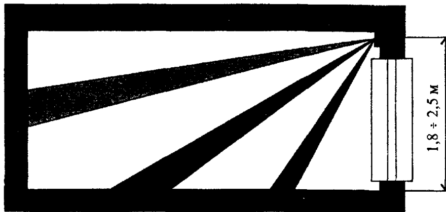
Рисунок 6.28 - Одновременная блокировка на проникновение стен, пола и потолка, а также объема помещения объемными пассивными опико-электронными извещателями
