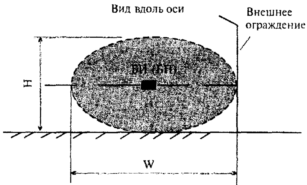
Рисунок 6.46 - Блокировка внешнего ограждения извещателем радиоволновым «Радий-1» («Радий-2»)
