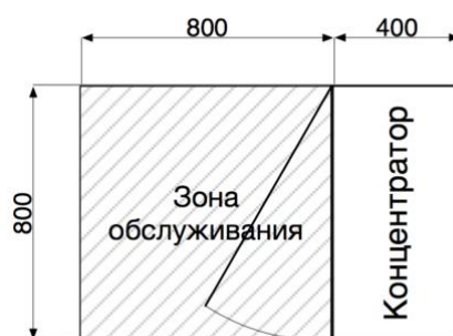
Рис. 1 Внешний вид и габаритные размеры концентратора с одностворчатой дверью
