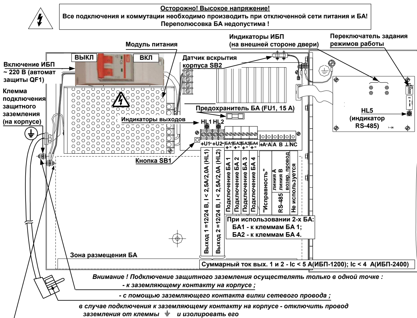
Рис. 2 Внешний вид ИБП-1200/2400 исп. 1 с открытой дверью
