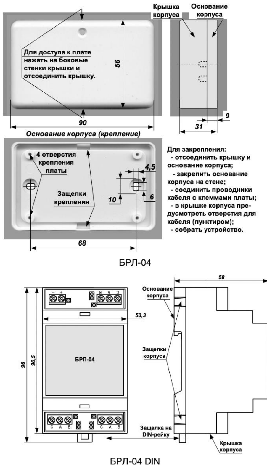
Рис. 3 Конструкция. Габаритные и присоединительные размеры.
