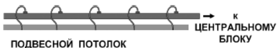
Рис. 29. Установка воздухозаборной трубы за подвесным потолком
